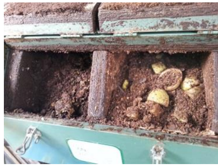
Compostaje de residuos orgánicos mediante composteras giratorias
